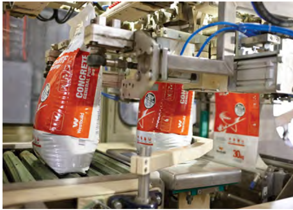
Figure 1. Remplissage de sacs de ciment avec la technologie FFS.
