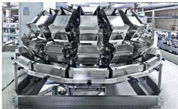
Peseuses multi-têtes : Modèle Asso Convient à tous types de produits, Personnalisables pour atteindre un rendement et une précision élevés
