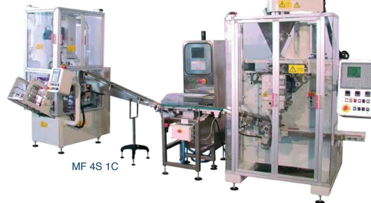
Ligne clef en main avec une ensacheuse 4 soudures pour produits en poudre et contrôle du poids dynamique et mise en étui verticale
