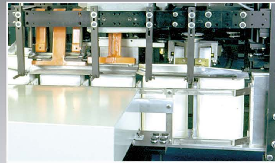
Fermeture de la tête du sachet par colle à chaud
