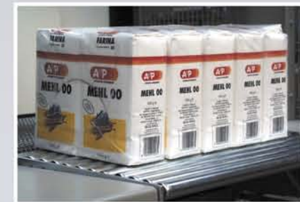
Sur demande: fardelage sous polyéthylène thermorétractable, et palettisation éventuelle
