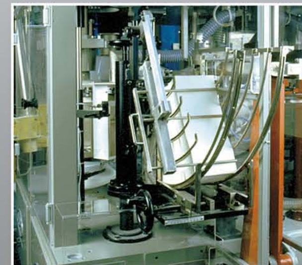
Sachet toujours tenu fermement/efficacement (ventouses + vide)
