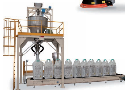
Ensacheuse CONTINUA FFS avec palettiseur PS-AA, du type à poussée avec alimentation par le haut
